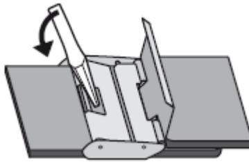
2. Klappe mit einem kleinen Werkzeug wie z.B. einem Schraubenzieher gemäß Abbildung aufhebeln.
