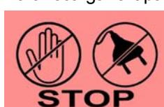
**ETIQUETA DE SEGURIDAD:** Una etiqueta de seguridad está colocada cerca del conector de electricidad. Esta etiqueta muestra una marca cuando la temperatura es más caliente que alrededor de 60 ° C. Cuando el color de la etiqueta cambia y pone de manifiesto las marcas, es imperativo que se desconecte el calentador, y no lo toque directamente. Cabe recordar que el calentador debe estar en su bolsa de la carga para evitar cualquier riesgo de quemaduras.
