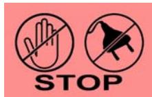
метки безопасности: безопасность этикетке проставляется рядом с электрическим разъемом. Этот знак свидетельствует заметно, когда температура теплее, чем на  $60^{\circ}\text{C}$ . Когда цвета этикетки и обнаруживает изменения маркировки, необходимо отсоединить обогреватель и никогда не касался непосредственно. Следует напомнить, что обогреватель следует в своей сумке при погрузке, чтобы избежать любого риска ожогов.
