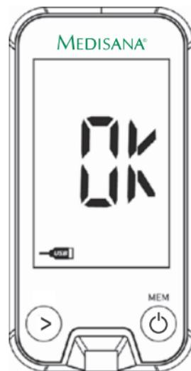
3. Nach beendeter Übertragung der Daten erscheint "OK" im Display und das Gerät gibt ein akustisches Signal aus.
