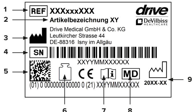
1 Référence | 2 Désignation | 3 Fabricant | 4 N° de série | 5 Code UDI | 6 Charge maximale | 7 Se conformer au mode d'emploi | 8 Dispositif médical | 9 Date de fabrication (année-mois)
