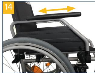
Zum Wegschwenken der Armlehne nach hinten, betätigen Sie den Entriegelungshebel vorn an der Armlehne und halten diesen, bei gleichzeitigem hochziehen der Armlehne, gedrückt bis die Armlehne frei ist. Nun kann sie nach hinten weggeschwenkt werden (**Bild 15+16**).
