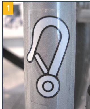
Als de rolstoel bijvoorbeeld met een galgkraan wordt opgehesen om hindernissen te overwinnen, mogen de hijspunten alleen de vier door een haaksticker aangegeven punten op het frame van de rolstoel zijn (**afb. 1**).
