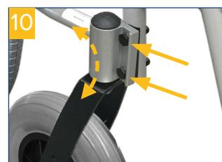
**Zorg ervoor dat u de schroeven na het instellen stevig aandraait en controleer of ze goed vast zitten!**
