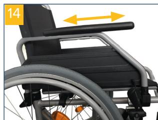
Pour escamoter l'accoudoir vers l'arrière, actionner le levier de déverrouillage qui se trouve à l'avant de l'accoudoir et le maintenir enfoncé tout en tirant l'accoudoir vers le haut, jusqu'à ce qu'il soit libéré. L'accoudoir peut alors être repoussé vers l'arrière (**fig. 15+16**).
