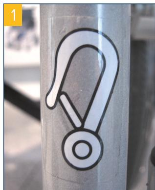
Se per superare un ostacolo la carrozzella deve essere sollevata, ad es. con una gru a paranco, i punti di sospensione da usare sono esclusivamente i 4 punti contrassegnati dall'adesivo con gancio sul telaio della carrozzella (**fig. 1**).
