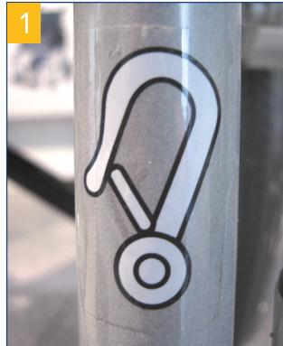
Muss der Rollstuhl mit z.B. einem Galgenkran zur Überwindung von Hindernissen angehoben werden, so dürfen die Anhängepunkte nur die vier, durch einen
