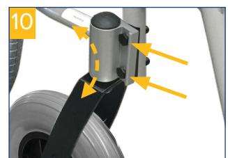
**Après avoir réglé l'angle de chasse, bien resserrer les vis et vérifier si les roues tiennent bien.**
