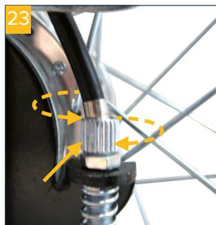
Pour régler le frein, commencer par desserrer le contre-écrou, puis serrer ou desserrer la vis de réglage. Cela fait, ne pas oublier de resserrer le contre-écrou en maintenant la vis de réglage au moyen d'une pince. Si le fauteuil roulant est manœuvré par un auxiliaire : pour freiner, presser les deux poignées de frein contre les poignées du fauteuil.
