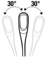
La tête de la lampe peut être ajustée latéralement (droite / gauche) dans un angle de 60 degrés (30 degré à la gauche et 30 degrés à la droite)..
