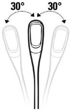
Der Lampenkopf kann seitwärts angepasst werden (rechts/links) innerhalb eines 60 Grad-Winkel (30 Grad nach links und 30 Grad nach rechts).
