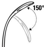
Le col de la lampe peut être ajusté verticalement (haut-bas) dans un angle de 150 degrés.
