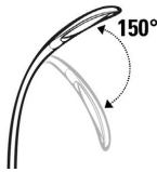
De hals van de lamp kan verticaal worden ingesteld (omhoog/omlaag) binnen een hoek van 150 graden.
