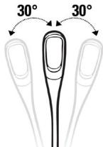
Het hoofd van de lamp kan zijwaarts worden aangepast (rechts/links) binnen een hoek van 60 graden (30 graden naar links en 30 graden naar rechts).
