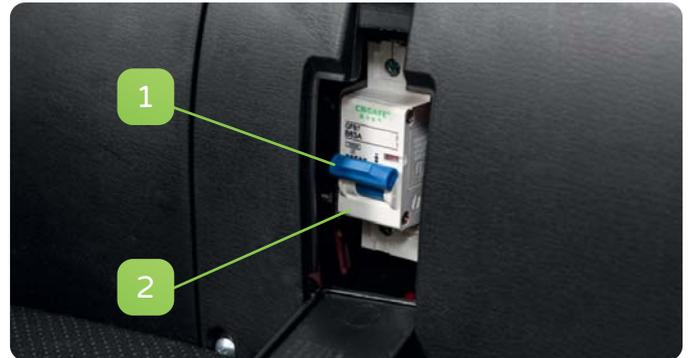
Position von Hauptsicherung und -schalter
