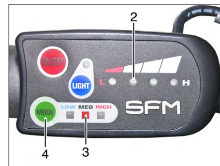
Die Spannungsanzeige (2) zeigt den Ladezustand des Akkus an.
