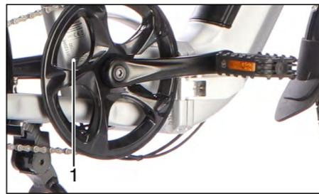
Die Rahmennummer (1) befindet sich auf der rechten Seite am Tretlagergehäuse.
