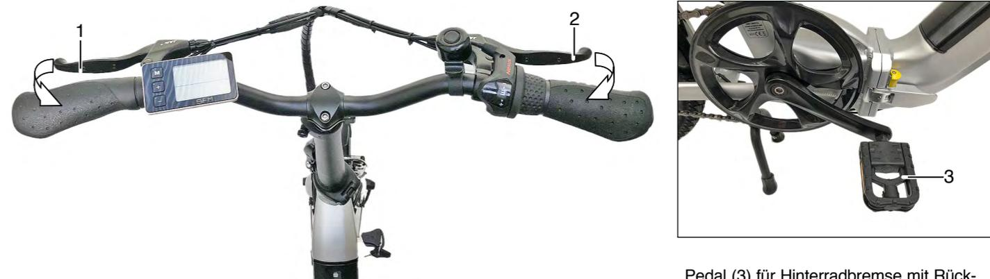
Handbremshebel (1) für Vorderradbremse
