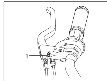
Durch Verstellen der Anschlagsschraube (1) kann der Handbremshebel zum Lenkergriff positioniert werden.
