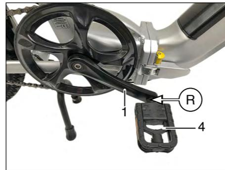
Überprüfen Sie regelmäßig, ob die Pedale (4) fest auf die Tretkurbeln geschraubt sind. Beachten Sie, dass die Pedale mit unterschiedlichen Gewinden ausgestattet sind.
