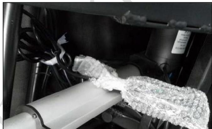
3. Tirez les câbles de la télécommande vers l'arrière pour qu'ils ne puissent pas être pincés ou endommagés. En cas de mauvaise manipulation et de non-respect des instructions, ainsi que des dommages qui en résultent, aucune demande de garantie ne peut être formulée!
