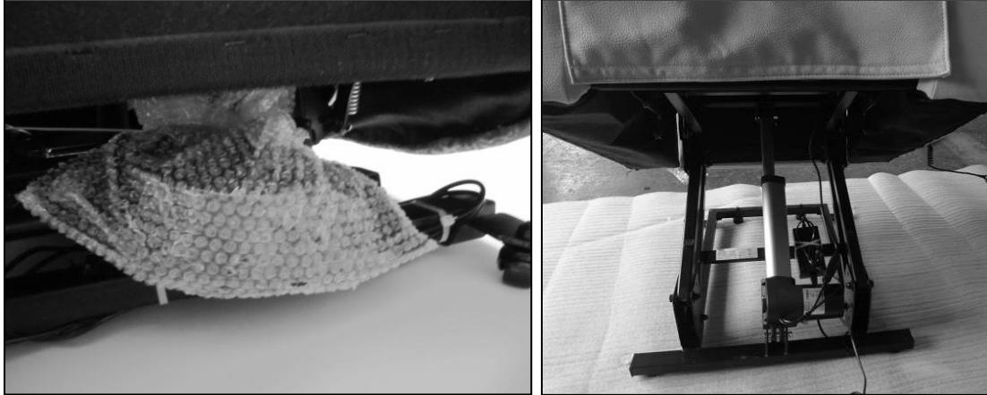
3. Führen Sie die Kabel der Fernbedienung nach hinten heraus, sodass diese nicht eingeklemmt oder beschädigt werden können. Für unsachgemäße Handhabung und nicht Beachten der Hinweise, sowie den daraus entstandenen Schäden, können keinerlei Garantieansprüche geltend gemacht werden!
